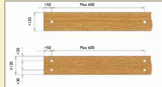
Maatvoering bevestigingspunten in mm.
