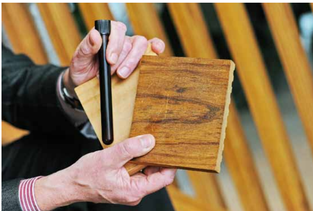
Radiata Pine, biohars en NobelWood. Het onbehandelde hout en de biopolymeren die aan het hout wordt toegevoegd met NobelWood als resultaat.
