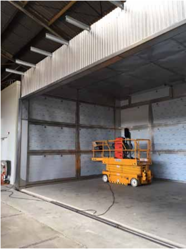
Curingkamer voor het op polymeriseren van de biohars in het hout
