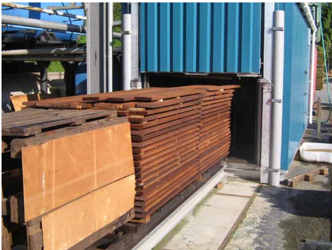
NobelWood in de droogkamer van de proefinstallatie
