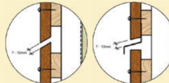
Afschuining minimaal 30 graden
